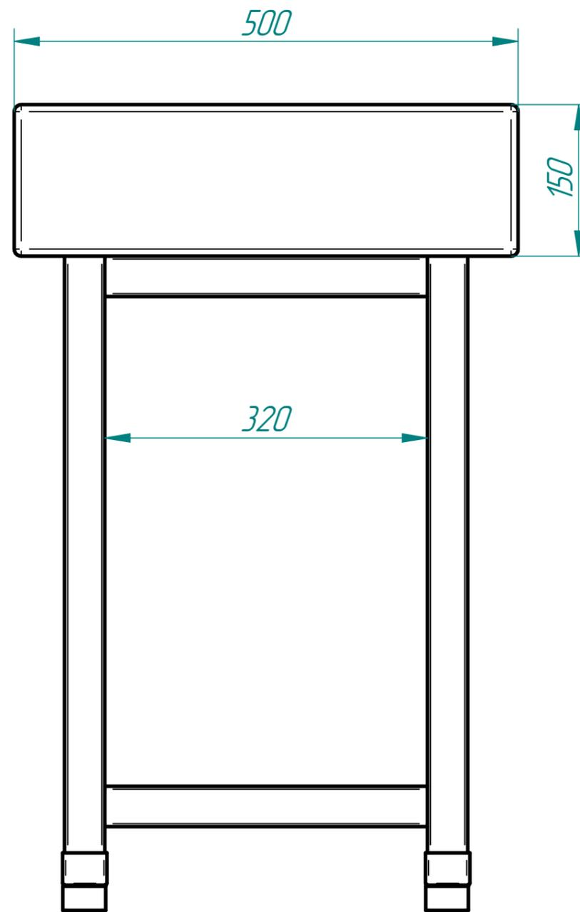
*Колода для рубки мяса, предназначена для использования на предприятиях общественного питания, в качестве вспомогательного оборудования, для выполнения работ, связанных с разделкой мяса. Столешница выполнена из древесины (бук клееный). Сварной крашенный каркас из стали выдерживает большие нагрузки. Колода имеет регулируемые по высоте ножки.*
